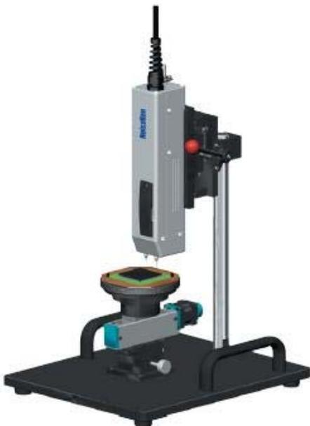
정밀 STAGE TYPE의 PROBE STAND는 최소분해능 0.01mm의 정밀도를 위하여, 밀리 PITCH (mm)나 인치 PITCH (Inch)등의 극소 PITCH의 반도체에 대해서 쉽게 시험을 행할 수 있다.
