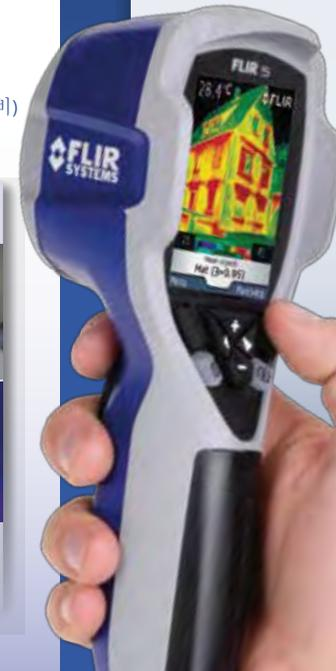
플리시시스템즈(FLIR Systems)사의 최신형 적외선 카메라인 i5는 초소형, 초경량 및 경제적 가격에 함께 실현한 적외선 열화상 카메라이다. 믿을 수 없는 사용 편의성으로 사용경험이 없는 사용자도 손쉽게 사용 가능하며, "조준-발사-감지(point-shoot-detect)"의 과정만으로 사용자가 필요로 하는 적외선 열화상 정보가 담긴 고화질의 적외선 열화상 이미지를 확보할 수 있는 시스템이다. 하지만 i5와 국부 고온측정기(spot pyrometer)와 혼동은 금물이다. 국부 고온측정기(spot pyrometer)는 특정부위의 온도만 기록할 뿐이고 i5는 전체 열화상 이미지를 기록하는 장비이다.
